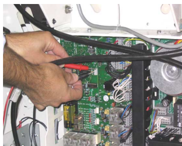
Fig. 11.4a Tension de commande continue
