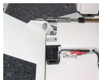
Fig. 5.1c Détail des contacteurs de sécurité
