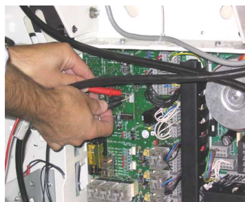
Fig. 11.4a Tension de commande continue
